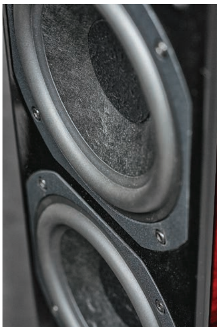
Przetworniki niskotonowe mają membrany celulozowe, zamknięte i usztywnione wklęsłymi nakładkami.
