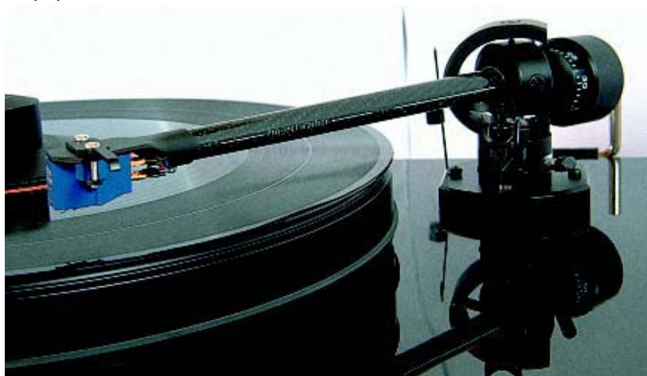
W gramofonie zastosowano ładne ramie węglowe 9c, w wersji z aluminiową główką.
