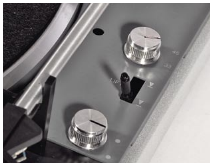
Pulpit z manipulatorami – wyłącznik, dźwignia opuszczająca ramię i przełącznik zmieniający obroty i informujący ramię o średnicy płyty.
