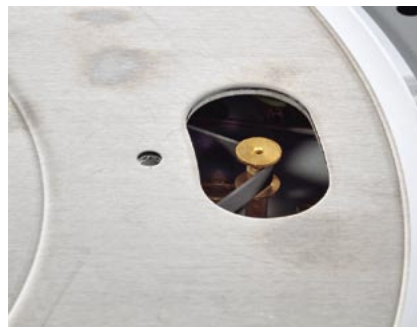
Rzut oka pod talerz – widać mosiężny wałek na osi silnika i płaski pasek napędowy.
