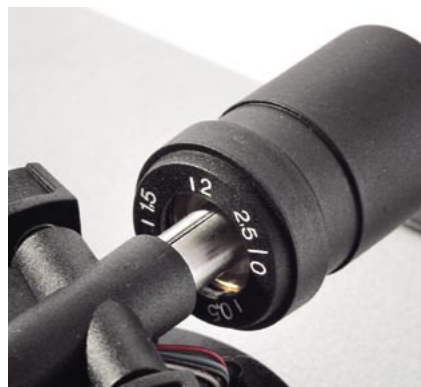
Przeciwwaga ma podłużny kształt. Z przodu jest mała tarczka, którą najpierw kalibrujemy, a potem możemy użyć do ustawienia nacisku igły. Sugerowałbym jednak skorzystanie z dobrej wagi elektronicznej.
