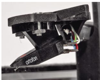
Gramofon ma wstępnie wyregulowaną wkładkę Ortofona OMB 10, o kształcie charakterystycznym dla wkładek DJ-skich.
