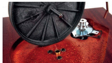
Sub-talerz z polerowanym trzpieniem; od spodu przykręcono mosiężną tuleję z ceramiczną kulką.
