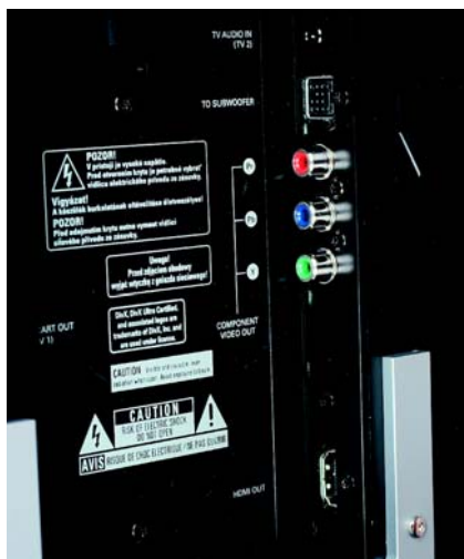
Z wyjściem HDMI współpracuje układ skalujący do formatu 1080i.
