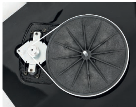
Napęd paskowy i brak elektroniki wymusza zdjęcie talerza do zmiany prędkości obrotowej.
