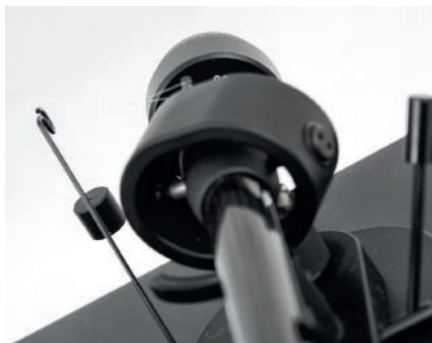
Klasyczny układ antyskatingu z ciężarkiem na żyłce.
