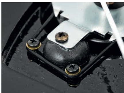
Prosty i skuteczny układ zawieszenia silnika, odsprężniętego od właściwego chassisa.
