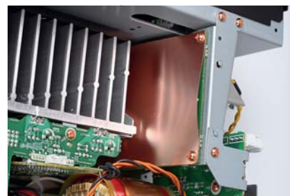
Elementy zasilacza zostały zaekranowane.
