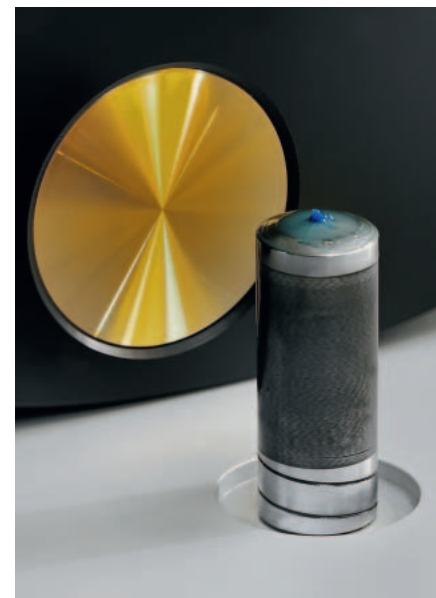
Łożysko talerza to sekret każdego konstruktora. Tutaj wykonane jest ze stalowego sztyftu, na którym mamy warstwę stopu; jego skład nie ujawniono. Na samej górze widać wypukłą płaszczyznę, wyglądającą jak odmiana Teflonu.
