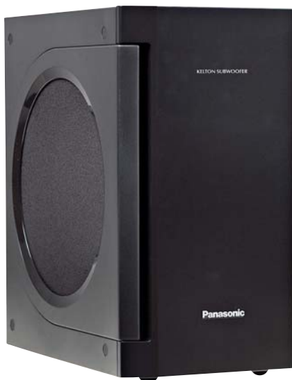
Pasmowoprzepustowa konstrukcja subwoofera promieniuje za pomocą 25-cm membrany biernej; 16-cm głośnik umieszczono wewnątrz obudowy.
