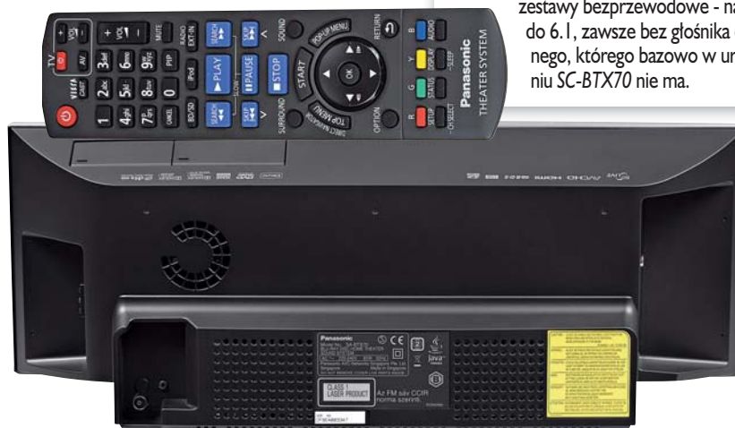
Płaska forma jednostki centralnej zachęca do montażu ściennego; jednak na tylnej ścianie nie przygotowano otworów.
