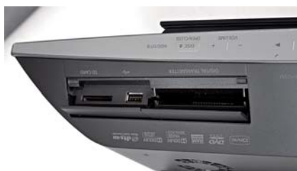
Obok klasycznych gniazdek, Panasonic ma także slot na karty SD, złącze USB oraz specjalny port dla karty rozszerzeń, umożliwiającej dołączenie bezprzewodowych głośników tylnych.
