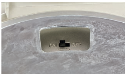
Pod metalowym talerzem umieszczono mały przełącznik konfiguracyjny, który decyduje o tym, czy korzystamy z wbudowanego przedwzmacniacza korekcyjnego, czy wyprowadzamy sygnał prosto z wkładki.
