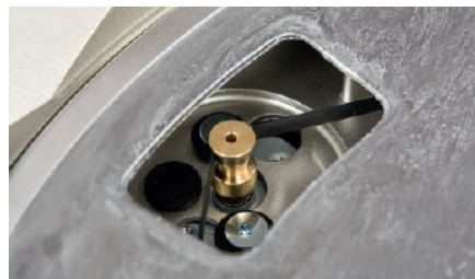
Mimo prostej konstrukcji, napęd jest paskowy.
