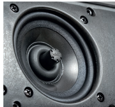
W zakresie „dolnego środka” wspiera ją para przetworników wyglądających dość tajemniczo, ale łatwo ustalić, że to część układu koncentrycznego, „ogolona” z przetwornika wysokotonowego.
