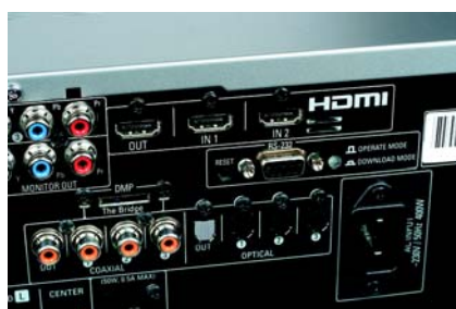
W towarzystwie portu DMP The Bridge i złączy HDMI osadzono RS-232 do sterowania. Jest nawet przycisk do resetowania i tryb wprowadzania oprogramowania.
