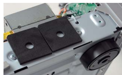
Aby zgasić vibracje obudowy, przyklejono do niej elementy tłumiące – jak w audiofilskich urządzeniach.
