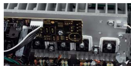
W konstrukcji końcówek mocy wykorzystano tranzystory Sankena.
