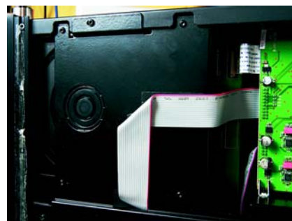
Modyfikowany napęd Philipsa VAM1202.
