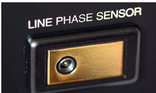
Luxman ma „hopla” na punkcie odpowiedniego zasilania, stąd obecność na tylnej ścianie czujnika fazy napięcia zasilającego.
