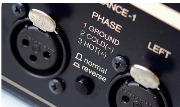
Wejścia zbalansowane mają obok mały przełącznik, którym zmieniamy ich fazę absolutną, tj. wybieramy „gorący” pin – nr 3 lub nr 2.
