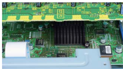
Główny układ wizyjny zaprojektowany przez Pioneerę przykryto dużym radiatorem.
