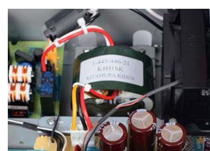
W rozbudowanym zasilaczu wydzielono sekcję (z transformatorem R-Core) tylko dla obwodów audio.
