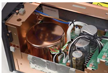
Część zasilacza z zaekranowanym transformatorem toroidalnym napędza obwody audio.
