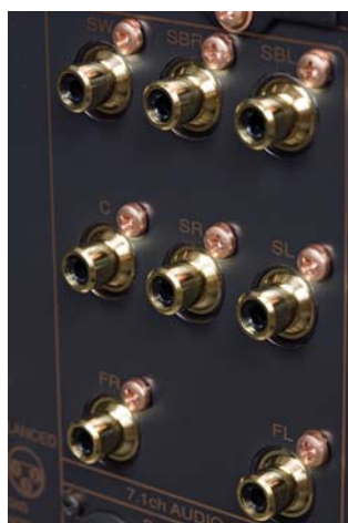
Oprócz HDMI, wielokanałowy zapis udostępniają także analogowe wyjścia 7.1.
