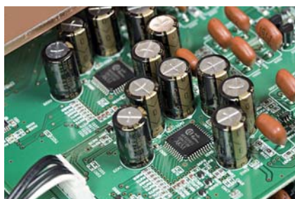
Konwersja cyfrowo-analogowa zachodzi w najlepszych przetwornikach AKM AK4399 z 32-bitowymi filtrami i natywną obsługą sygnałów DSD.
