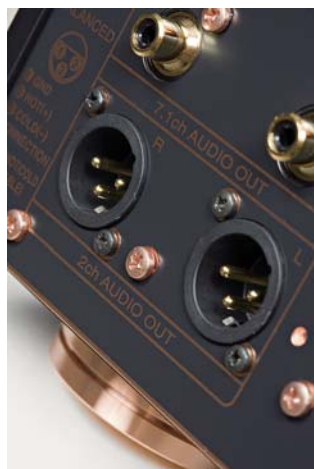
Wyjście dwukanałowe potraktowano priorytetowo, montując (wyłącznie) gniazda XLR.
