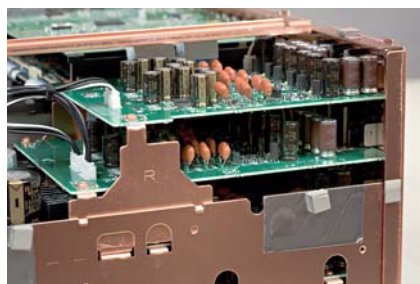
Sekcja audio złożona z czterech niezależnych płytek - tak jak w odtwarzaczu audio SA-7S1.
