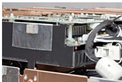
Między płytkami wideo umieszczono procesor graficzny Silicon Optix (tuż za nim pracuje wentylator chłodzący).
