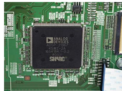
Procesory linii Sharp są od lat wykorzystywane przez Denona do dekodowania wielokanałowego dźwięku.
