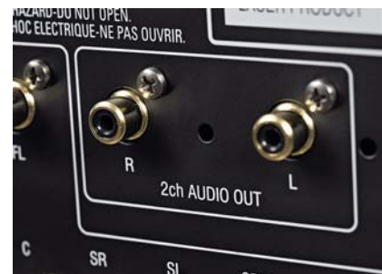
Obok wielokanałowych wyjść jest także specjalna analogowa para stereofoniczna.
