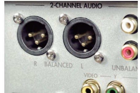
Sekcję stereofoniczną potraktowano z najwyższą atencją, instalując oprócz wyjść RCA także zbalansowane XLR-y.
