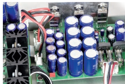
W zasilaczu bardzo starannie przygotowano sekcję filtrów i stabilizatorów.
