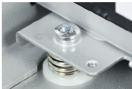
Mechanizm odseparowano od podłoża sprężynowymi tymbkami drgań.
