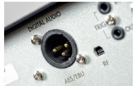
Cyfrowe wyjście AES/EBU – to wyposażenie najlepszych audiofilijskich źródeł.
