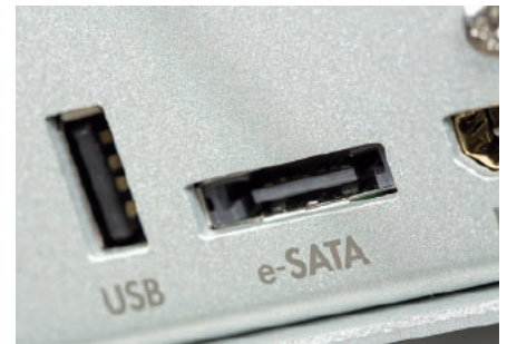
Zewnętrzny dysk twardy można podłączyć przez USB lub znacznie szybszym złączem e-SATA.
