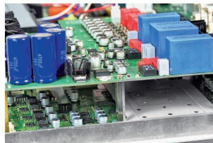
Na dolnej płytce umieszczono układy wideo. Tam też, pod radiatorom, znajduje się świetny procesor wizyjny Marvel QDEO.
