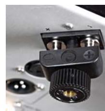
Nietypowe zaciski głośnikowe najchętniej obsługują końcówki widelkowe. W teście udało się nam namówić je na współpracę z bananami, ale wówczas plastikowy docisk, znajdując się zbyt daleko, może się obrócić, a wtedy możemy pomylić plus z minusem...
