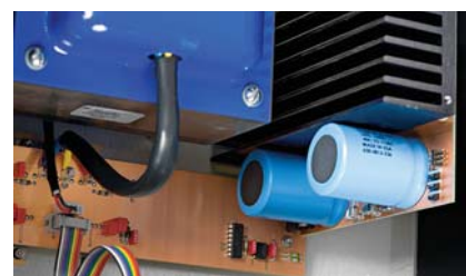
Na płytkach końcówek znalazły się również elementy zasilacza - kondensatory filtrujące.
