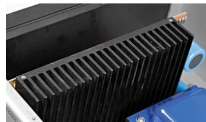
Każdy kanał został uzbrojony w prosty, ale potężny radiator, który odprowadza ciepło aż z 16 tranzystorów.
