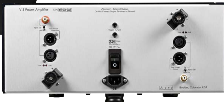
Oprócz wejścia XLR, prowadzącego do zbalansowanego układu wzmacniacza, jest też wyjście w tym standardzie, ułatwiające podłączenie drugiej końcówki mocy – np. do układu bi-amping.
