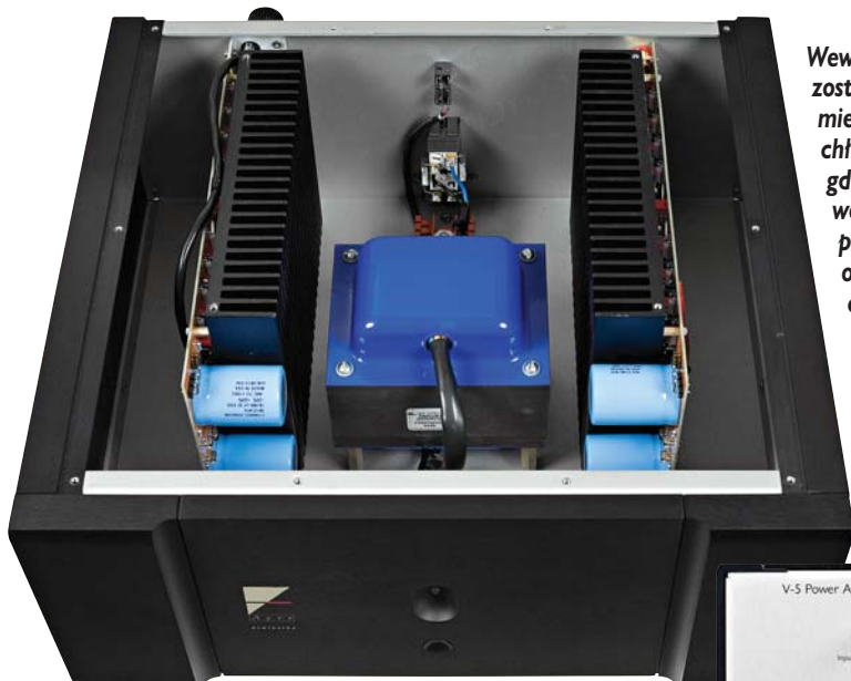
Sekcje wejść i wyjść obydwu kanałów są względem siebie odwrócone o 180°. To nie fanaberia, ale konsekwencja układu wewnętrznego
