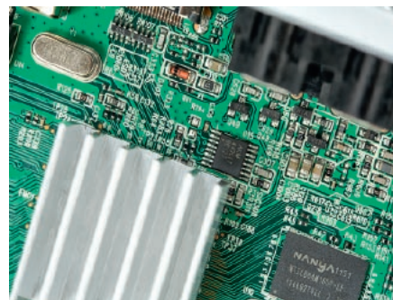
Sygnal dla wyjścia analogowego przygotowuje stereofoniczny przetwornik AKM delta-sigma, oczywiście 24 bit/192 kHz.
