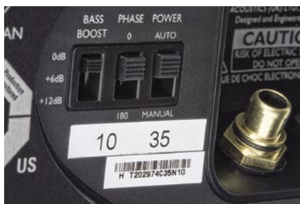
Wyposażenie jest prawie minimalistyczne – tylko jedno wejście RCA (dla sygnału LFE), przełącznik trybów włączania, przełącznik fazy, ale też nietypowa regulacja kształtu charakterystyki.
