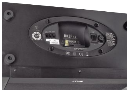
Terminal przyłączeniowy zainstalowano w dolnej ścianie, dzięki czemu subwoofer można będzie przysunąć do ściany.
