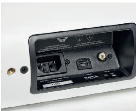
W terminalu przyłączeniowym tylko gniazdo sieciowe, pojedyncze RCA dla sygnału LFE (A stereo? A co to stereo?) i łącze USB – do podłączenia „Perfect Bass Kit” (PBK).
