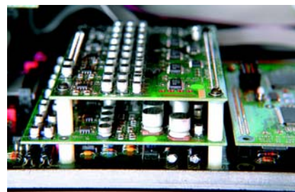
Centrum audio – na górze płytka z upsamplernami (dla wszystkich kanałów), poniżej scalone drabinki rezystorowe i bufony, a po prawej płytka z układami DSP.
