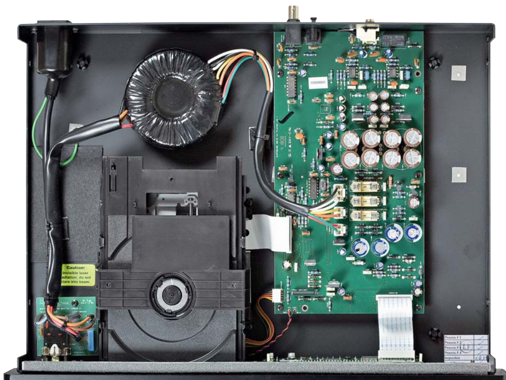
Transport, transformator i niemal cała elektronika zmieściły się na jednej drukowanej płycie.
