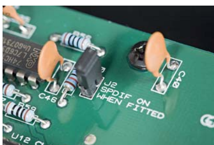
Wewnętrzna zwora pozwala odłączyć cyfrowe wyjście.
