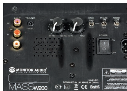
Pozornie niepozornie... trzy gniazda RCA (parka stereo plus LFE), dwa pokrętła (wzmocnienia i filtrowania), hebeleki fazy, trybu włączania... ale co to jest „bass”? To trójpozycyjny przełącznik kształtu charakterystyki. Jak działa – sprawdziliśmy w laboratorium.
