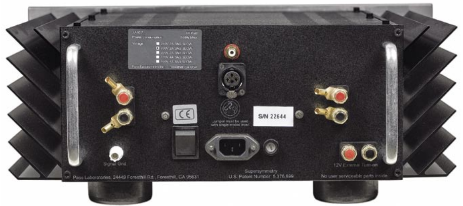
Pośrodku zasilanie, wejścia RCA i XLR, a po bokach gniazda głośnikowe.
