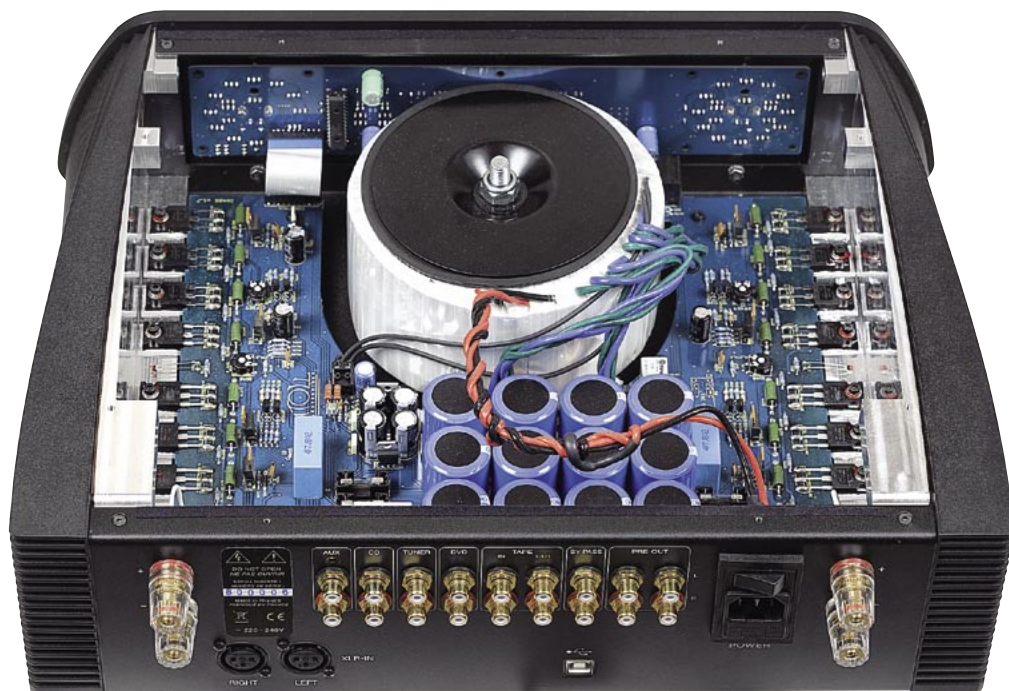
Potężny transformator i reszta zasilacza zajmują większą część konstrukcji.
