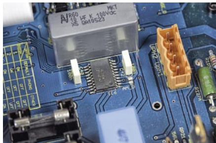
Tłumienie sygnału odbywa się w scalonych drabinkach rezystorowych.
