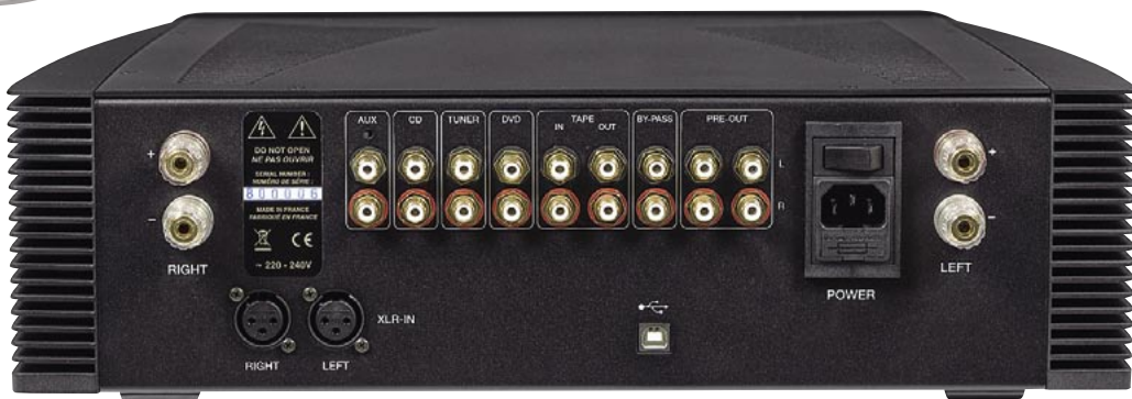
IN400 ma sporo przyłączy, choć gniazda głośnikowe są pojedyncze.
