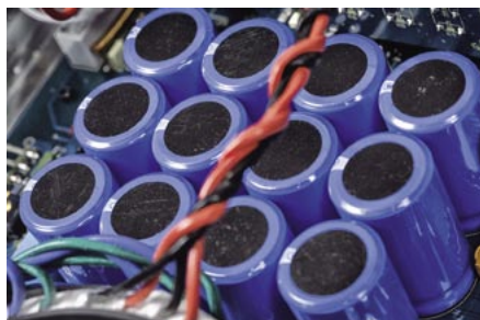
Bank dużych kondensatorów przeznaczono dla końcówek mocy.
