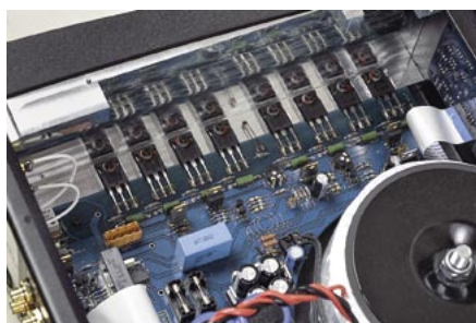
Końcówkę oparto na tranzystorach MOSFET, po cztery pary na kanał.
