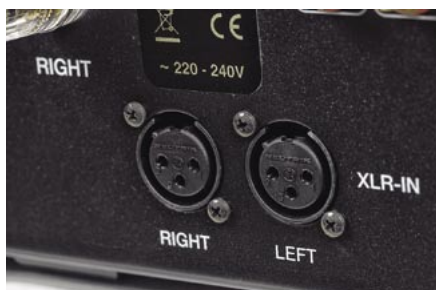
Wejścia liniowe XLR z pinem gorącym nr 2 – sygnał za nimi jest jednak desymetryzowany.
