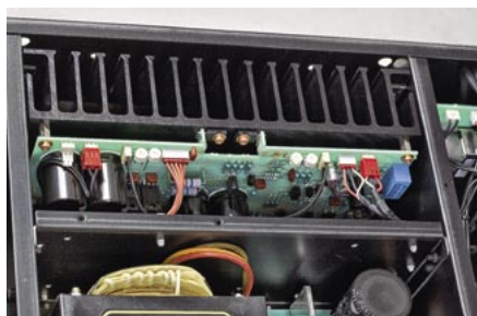
Jeden kanał mocy - płytka przykręcona do odlewane-go, solidnego radiatora.
