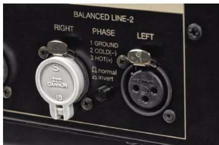
Wejścia XLR z poręcznym przełącznikiem „gorące” pinu - albo nr 2, albo 3
