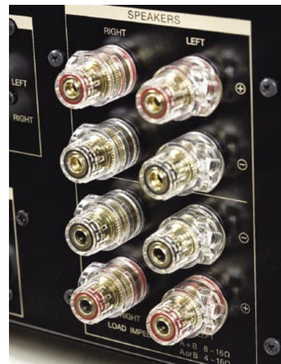
Podwójne wyjścia głośnikowe ułatwiają bi-wiring.
