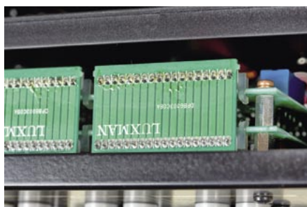
Układy wejściowe podzielono między dwie płytki, połączone małymi płytkami-zworami.
