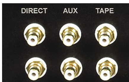
„Direct” pozwala ominąć potencjometr i wejść bezpośrednio na końcówkę mocy.
