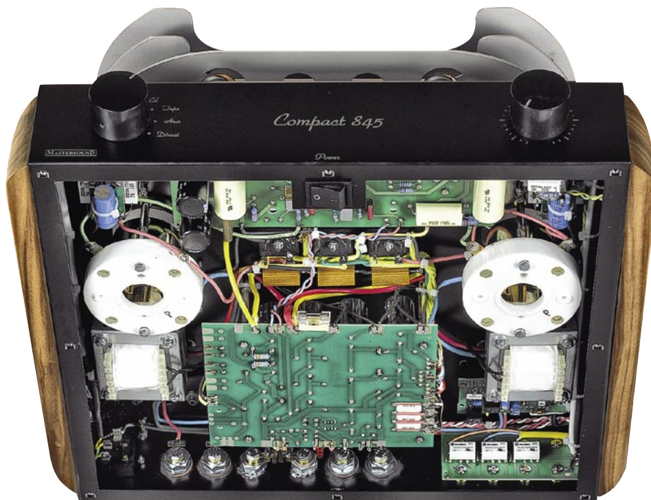
Budowa tego wzmacniacza jest mieszana - częściowo typu punkt-punkt (końcówki), a częściowo za pomocą drukowanych płytek (reszta układów).
