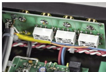
Selektor wejść na przełącznikach wlotowo bezpośrednio do płytki z gniazdami wejściowymi.
