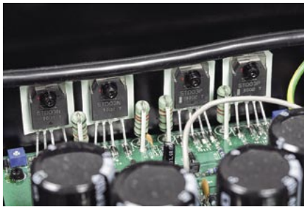
Dwie pary wydajnych układów Sankena na kanał - końcówki w M6i są jednymi z potężniejszych, jakie można spotkać we wzmacniaczu zintegrowanym.
