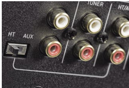
Jedno z wejść liniowych można „uzbroić” w tryb HT, co w praktyce oznacza bezpośrednie wejście na końcówki mocy.
