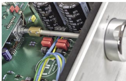
Potencjometr Alpsa podwieszono pod płytą przedwzmacniacza – widać oś przedłużoną do przedniej ścianki.
