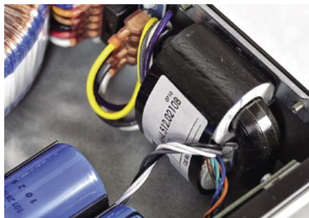
Piękny transformator R-core – specjalnie dla przedwzmacniacza.
