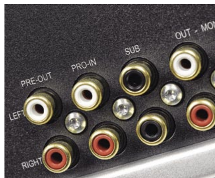
Wejście i wyjście z przedwzmacniacza oraz... osobne wyjście stereo dla subwoofera!
