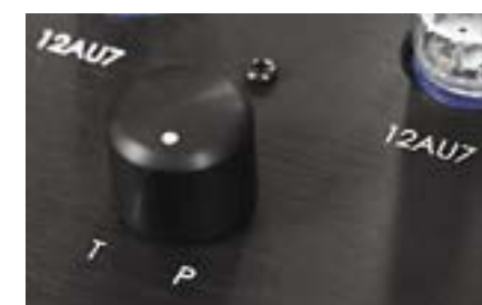
Przełącznik między trybami pracy lampy końcowej – „Triode” i „Pentode”... mimo że KT88 to tetrody.
