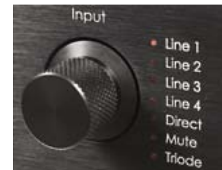
Efektowna i wygodna moletowana gałka, a obok niej rząd diod wskazujących wybrane wejście i tryb pracy.
