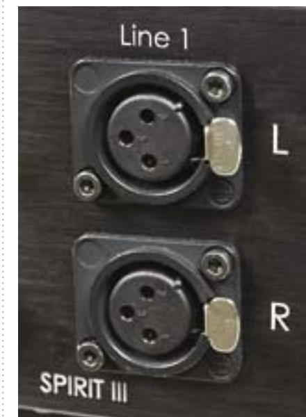
Gniazda XLR – pin ujemny jest w nich spięty z masą, wewnętrzna konstrukcja nie jest zbalansowana.
