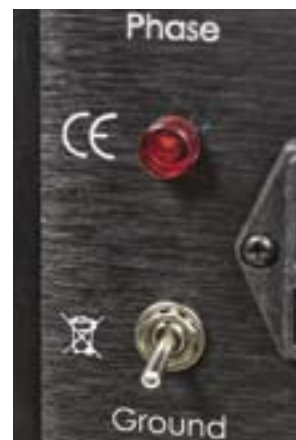
Złe podłączenie kabla sieciowego (odwrócenie fazy) sygnalizuje specjalna lampka, jest też przełącznik odłączający masę od obudowy.
