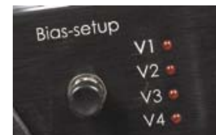
Przycisk i diody sygnalizujące pracę układu automatycznego biasu to innowacyjna technologia Gerharda Hirta.
