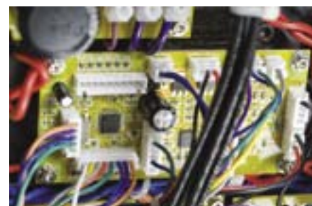
Płytkę z logiką i zabezpieczeniami to „mózg” tego nowoczesnego wzmacniacza.
