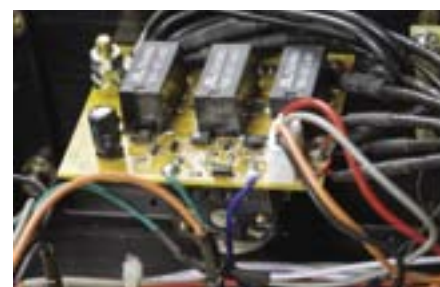
Mala płytka z przekaźnikami przy potencjometrze Alps – dalej sygnał biegnie albo do lamp wejściowych, albo prosto do końcówki (funkcja Direct).
