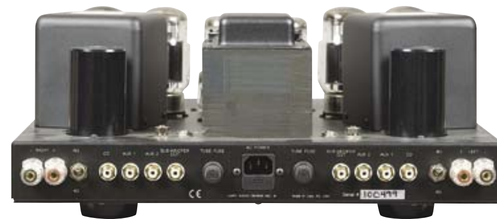
Za transformatorami głośnikowymi ukryto kondensatory zasilacza. Im lepiej chłodzone, tym dłużej pożyją.
