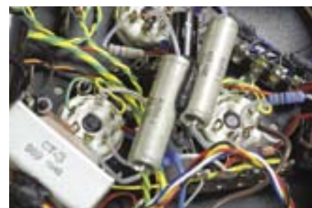
Kondensatory sprzęgające – olejowe!
