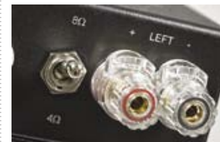
Praktyczne gniazda głośnikowe – złożone z plastikowymi osłonkami. Bez zdublowanych zacisków dla różnych obciążeń, ale za to z przełącznikiem.
