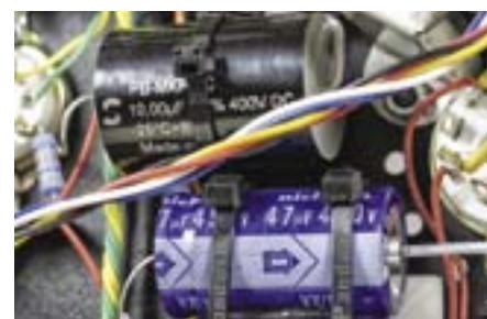
Ładne kondensatory – Solena (polipropylenowe) i Nichicon (elektrolityczne).
