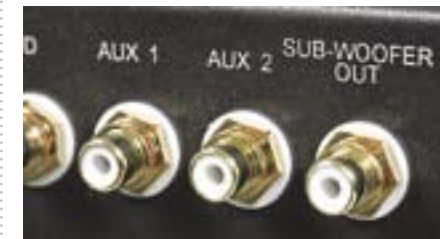
Wejścia RCA z teflonowym dielektrykiem i wyjście dla subwoofera – po prostu wyjście z przedwzmacniacza.
