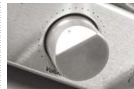
Dużą gałkę siły głosu ulokowano na środku przedniej ścianki – bo coś jest ważniejsze we wzmacniaczu od wzmocnienia... Potencjomet to Alps z silniczkiem - nawet klasyk Cary jest zdalnie sterowany, chociaż z pilota regulujemy tylko głośność. Można to nazwać minimalistycznym zdalnym sterowaniem...
