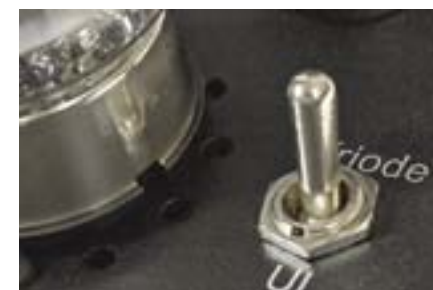
Przełącznik między pracą w triodzie a układem ultraliniowym – coś w rodzaju wyboru między jakością a ilością... choć nie do końca.
