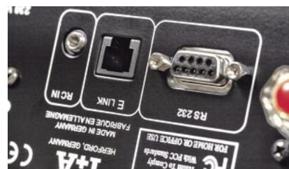
Wzmacniacz można wpiąć w system automatyki a także połączyć z innymi komponentami T+A magistralą E-Link.
