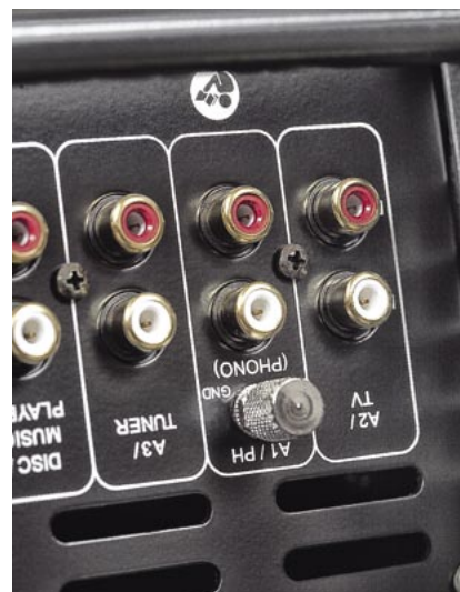
Jedno z wejść wyposażono w zacisk masy – można bowiem w Power Plancie zainstalować opcjonalną płytkę z przedwzmacniaczem gramofonowym.
