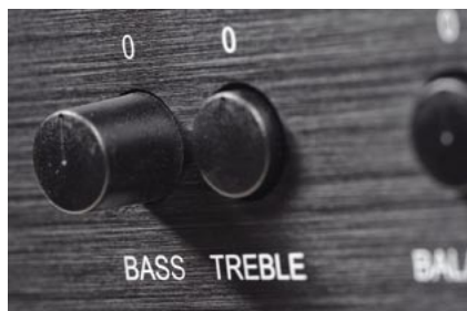
Regulacja barwy dźwięku – żeby przekreślić galkę, trzeba ją lekko nacisnąć, aby się wysunęła. Po regulacji możemy ją na powrót zlicować ze ścianką przednią.
