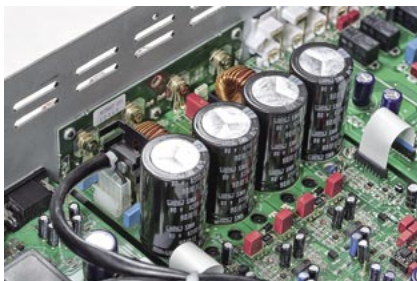
Moduł końcówki mocy. Oprócz dużych kondensatorów mamy tu też cewki filtrów wyjściowych.
