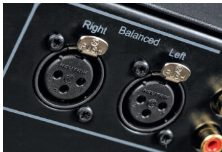
Gniazda XLR dostarczył Neutrik i warto z nich skorzystać nie tylko dlatego – H300 ma układ zbalansowany.
