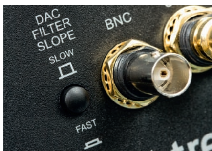
W sekcji wejść cyfrowych i przetwornika DAC dodano przełącznik trybów pracy filtra wyjściowego.
