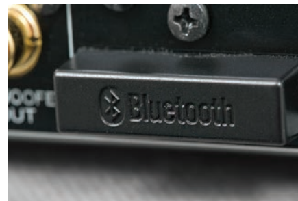
Pod plastikowym kapslem znajdują się anteny systemu Bluetooth.
