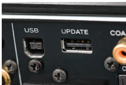
Obydwa wejścia USB z tyłu: jedno jest wejściem na wbudowany przetwornik C/A, drugie służy tylko do aktualizacji oprogramowania.
