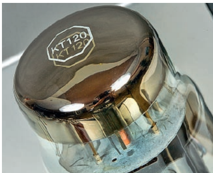
Jedna z najnowszych „cudownych broni” lampowego świata audio – tetroda strumieniowa KT120.
