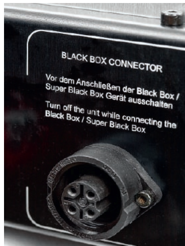
Czteropinowe gniazdo pozwala podłączyć albo Black Box, albo Super Black Box – z jeszcze większą pojemnością kondensatorów.
