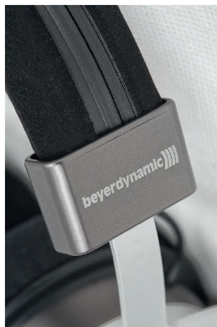
Mechanizm regulacji ma duży zakres, a pod miękką osłonką pałąka trzeba było także wygospodarować miejsce dla kabla łączącego przetworniki L i R.
