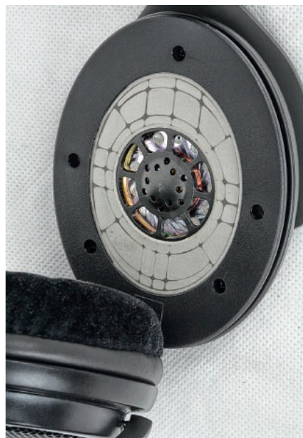
W każdej muszli zainstalowano 40-mm przetwornik z magnesem neodymowym.
