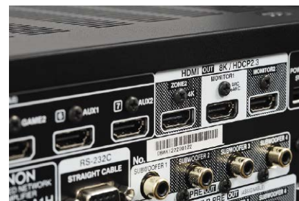
Wszystkie gniazda HDMI obsługują każdy typ sygnałów; siedem wejść, trzy wyjścia, w tym jedno dla zdalnej strefy.
