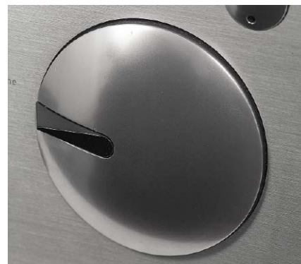
Pokrętko głośności prowadzi do typowego potencjometru.
