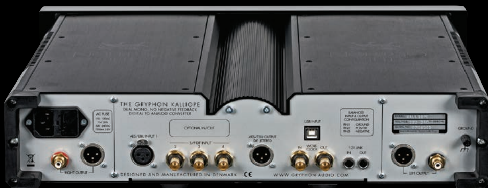
Kształt górnej sekcji obudowy jest charakterystyczny dla Gryphona, podkreśla podział wewnętrznych układów na dwa bloki, niezależnie dla każdego kanału. Wśród różnych wejść i wyjść najwięcej obiecują cyfrowe USB i analogowe XLR-y.
