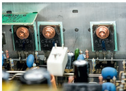
Sygnały po konwersji C/A trafiają do konwencjonalnych, analogowych wzmacniaczy; w każdym kanale pracuje para tranzystorów Sanken 2SA1695 + 2SC4486.
