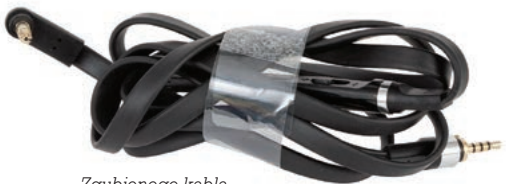
Zgubionego kabla nie będzie można zastąpić standardowym. Z jednej strony 4-polowy mikro-jack z „zasadką” w postaci dodatkowego zęba, z drugiej – już mini-jack, ale też 4-polowy.
