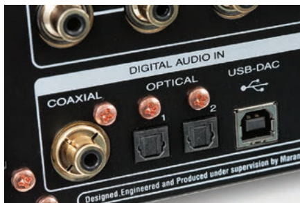
Sekcja cyfrowa przerosła analogową, jest w niej również port USB, mobilizujący zintegrowany przetwornik C/A do największego wysiłku.
