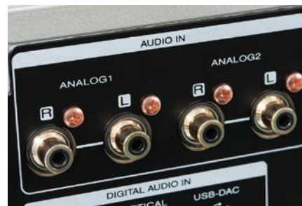
Wejścia analogowe ze znakomitymi złączami RCA – szkoda, że żadne z dwóch źródeł nie może być gramofonem...
